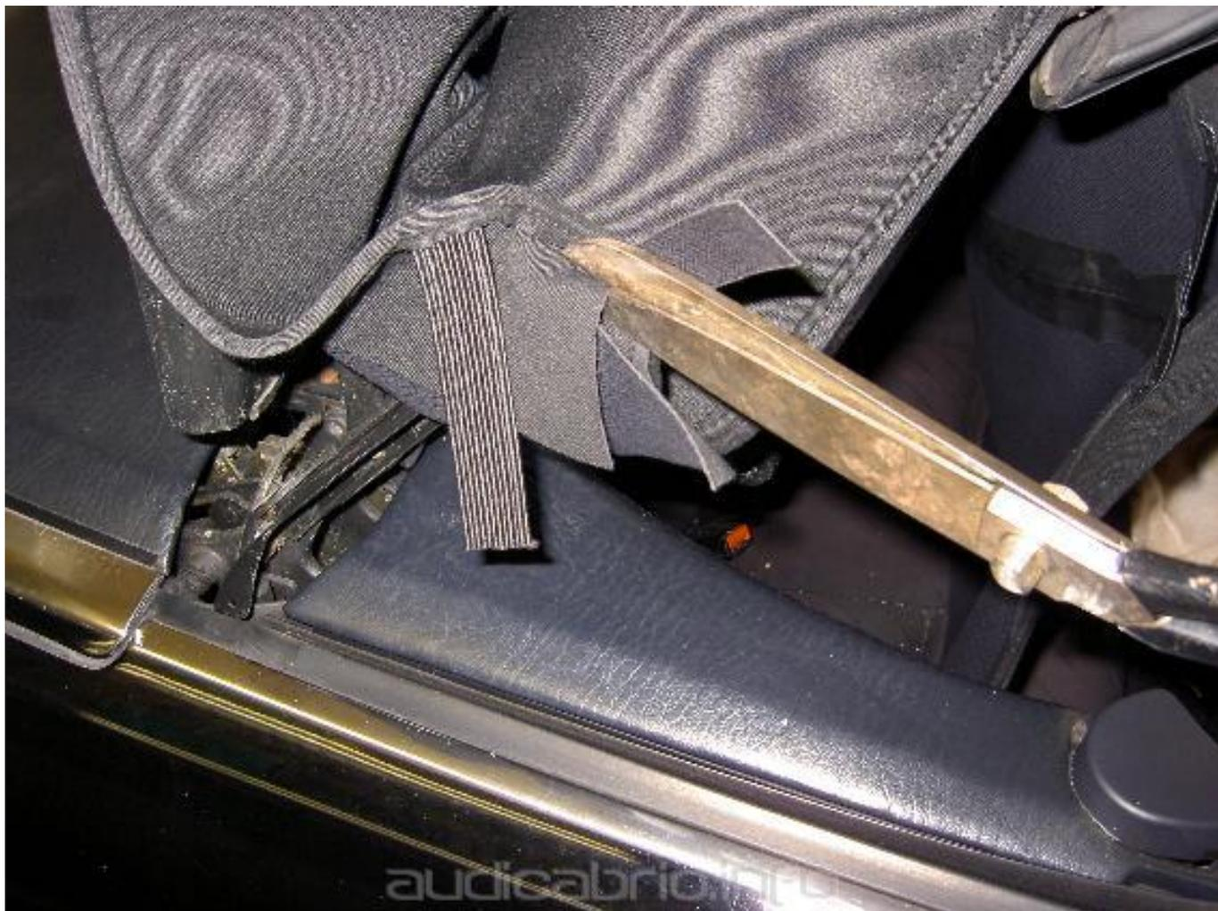
Das neue Verdeck hat in der Mitte (vorn und hinten) von mir eine Markierung bekommen (siehe Bilder 1 + 2), mit denen genau zentriert werden kann. Zentrierung über C-Säulen Ecken alleine ist zu ungenau. Hier soll das ganze noch nach links.
