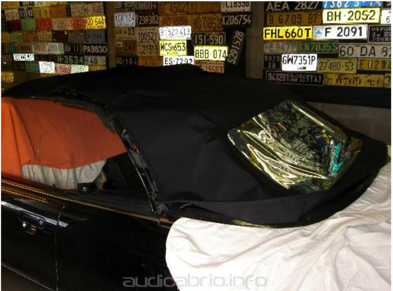
Das Neuteil wird auf dem Gestänge gelegt und der hintere Heckspiegel hoch geklappt. In diesem Zustand muss aufgepasst werden das das Verdeck nicht zwischen den Gestängeteilen kommt; die können wie eine Schäre wirken !
