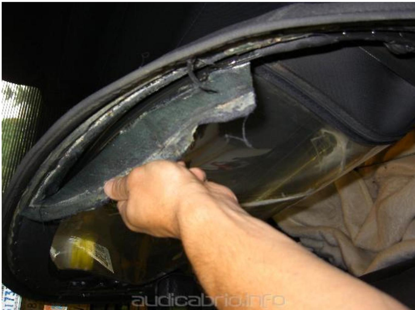
Der Lappen innen (Himmelstoff) unter dem Heckfenster wird gelöst.
