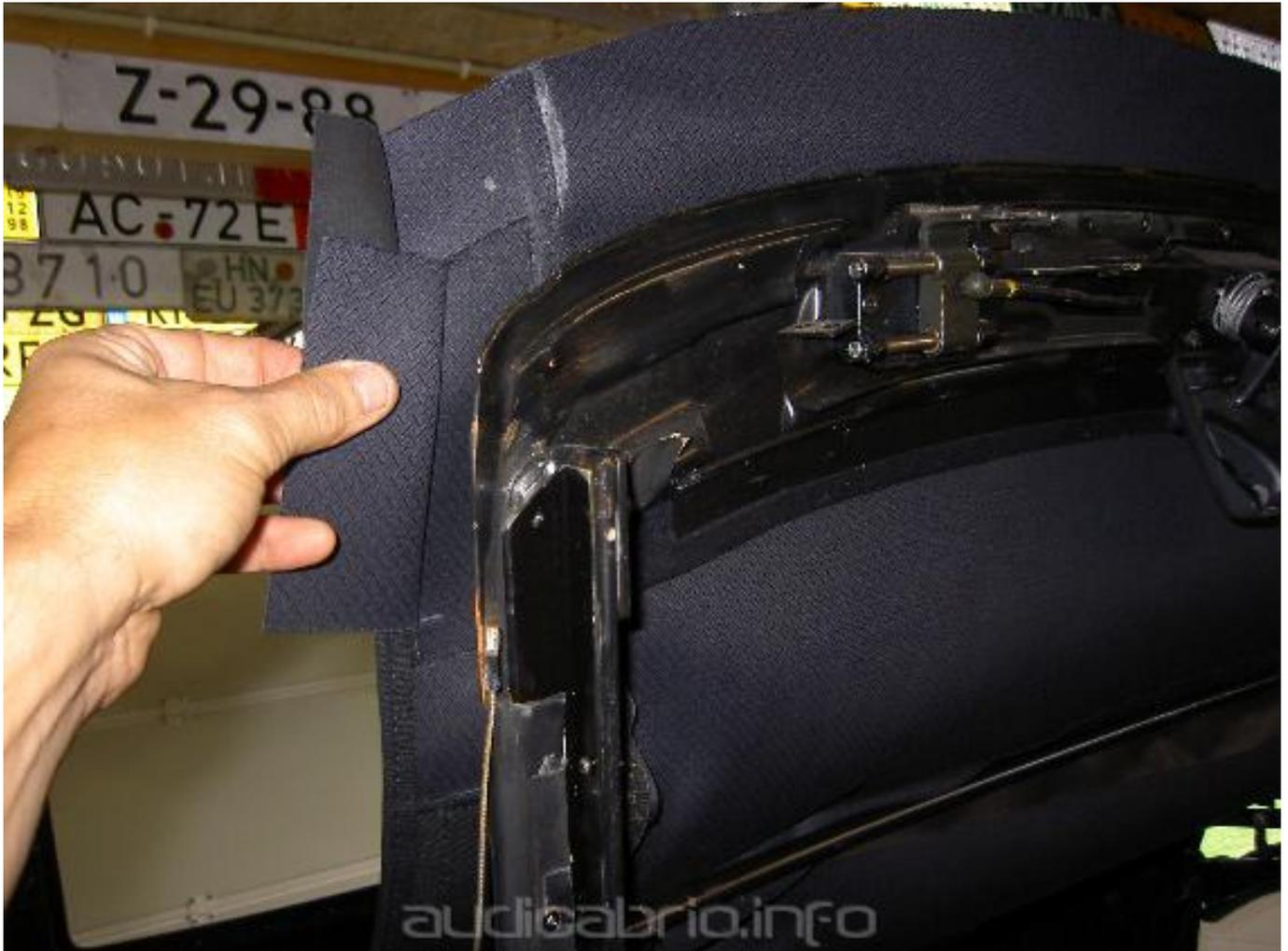
Ich habe an diesen Moment auch mal das Verdeck um den Vorderspiegel geklammert (mit Hilfe jeder Art von Klammern und auf den Längsnähten mit Krippzangen) und vorsichtig runter gelassen. An den Ecken vorne sind auch zwei kleine Taschen genäht. Zum "Probespannen" kann man die nicht benutzen; sie würden reisen !
