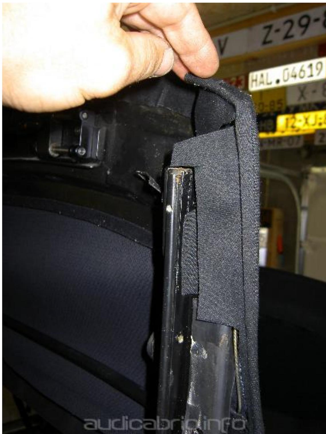
An den Ecken links und rechts vorne muss einiges geschnitten werden und in mehrere Schichten geklebt werden. Den rest der "Regenrinne" muss um etwa 45 Grad geklebt werden.
