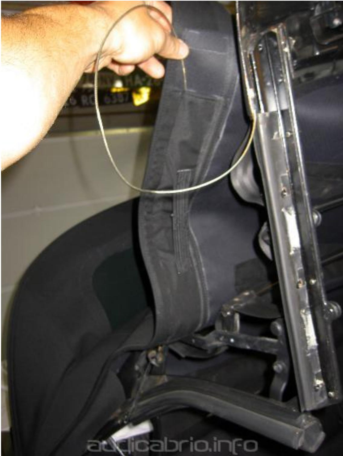
Vorne wird das Spannseil an beiden Seiten nach hinten geführt, durch die vorgesehene Tasche. Festschrauben samt Feder kommt erst viel später.
