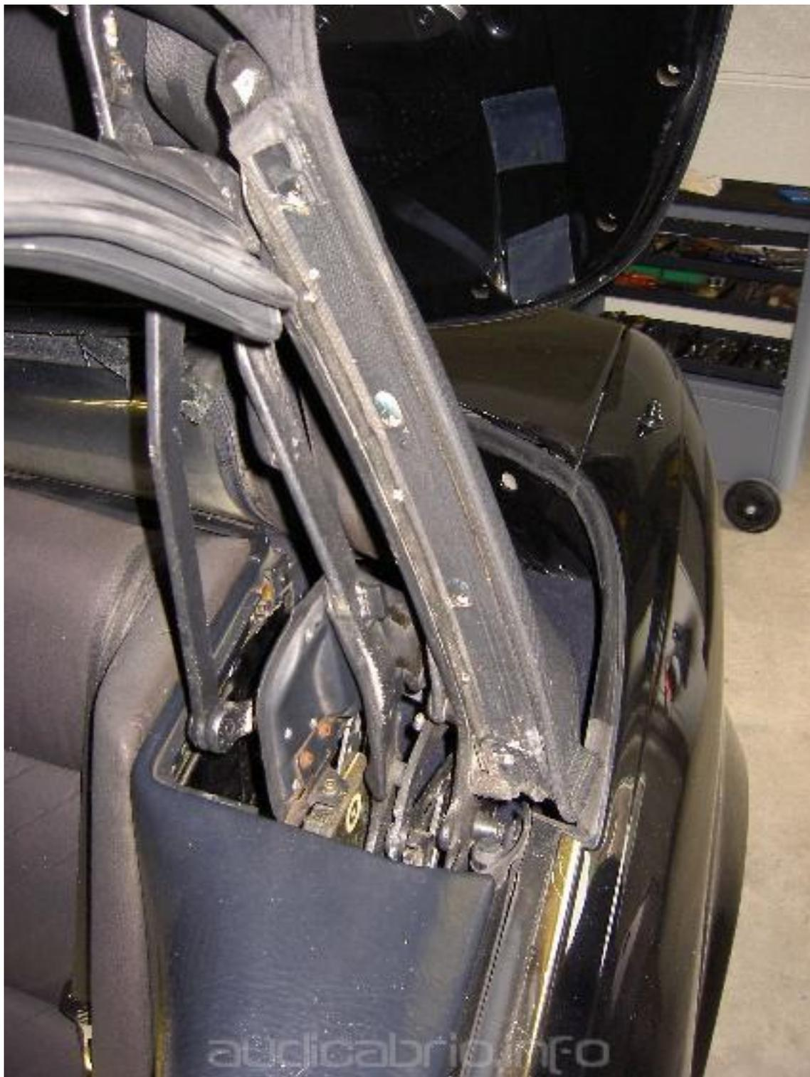
An der C-Säule ist auch das Profil samt Fenstergummi zu entfernen und das geklebte Verdeck zu lösen.
