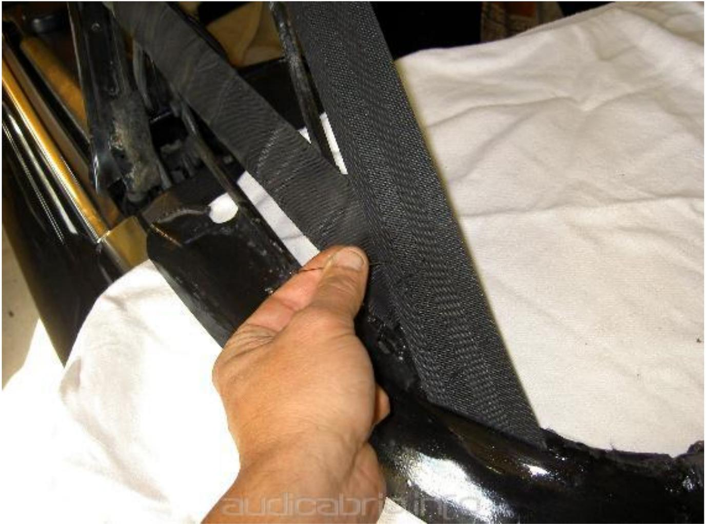
Die Spannbänder waren in Ordnung, nur zwei Gummis die an der Unterseite dran genäht sind, waren ausgeleiert. Ich habe sie nicht ersetzt weil dessen einzige Funktion ist, das falten beim öffnen zu unterstützen.
