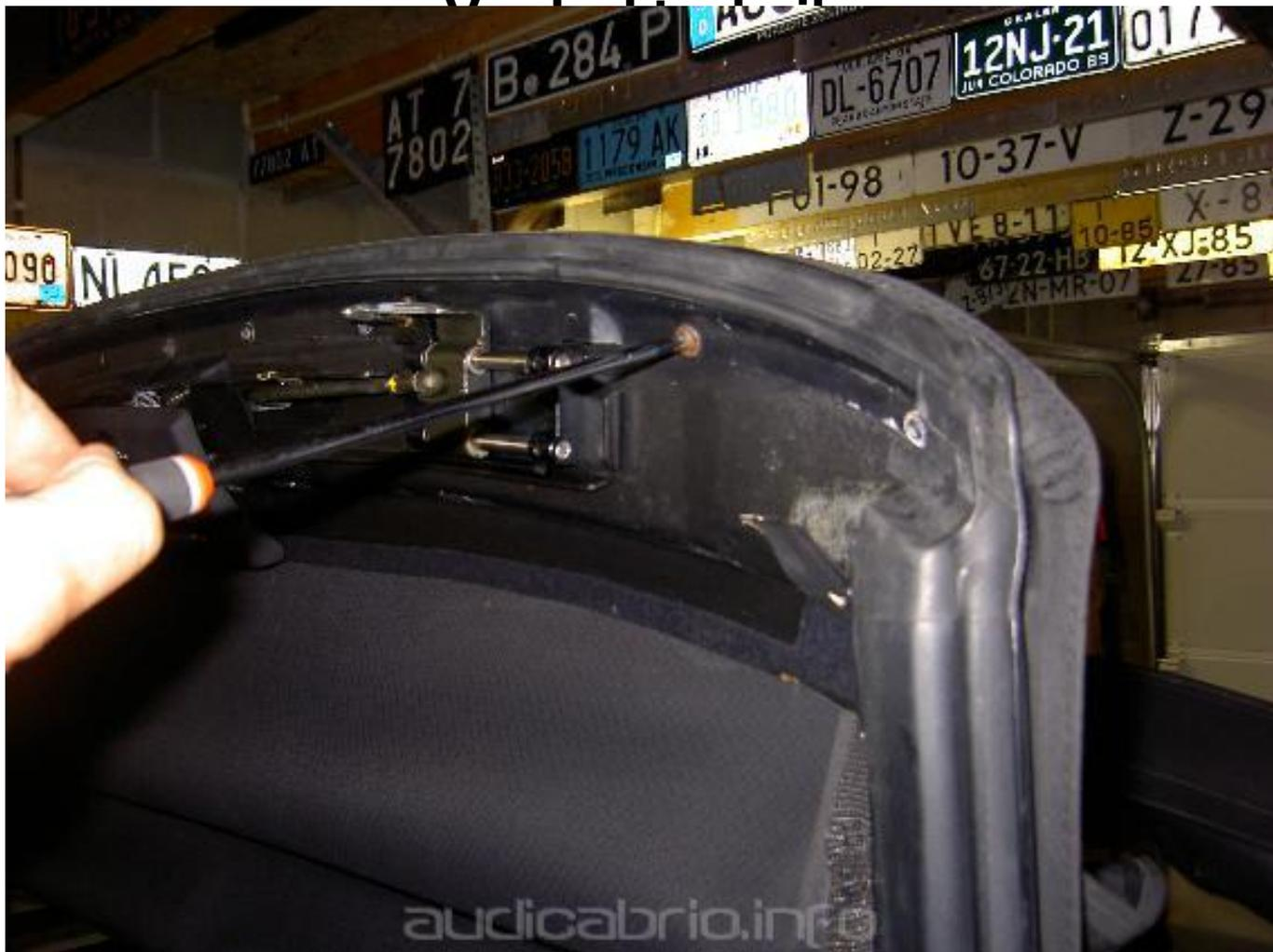
Am Vorderspiegel wird die Gummileiste entfernt und der ganze vordere Gummi abgenommen. Zwei kleine Gummiblöckchen wären mir fast verloren gegangen...
