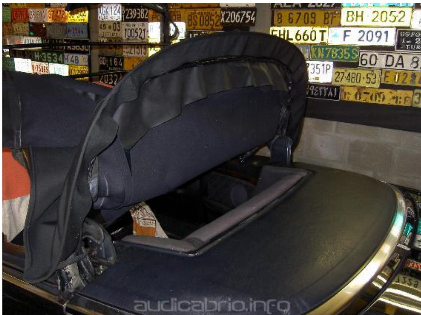
Die beiden hinteren Stofflappen werden um den Heckspiegel gelegt.
