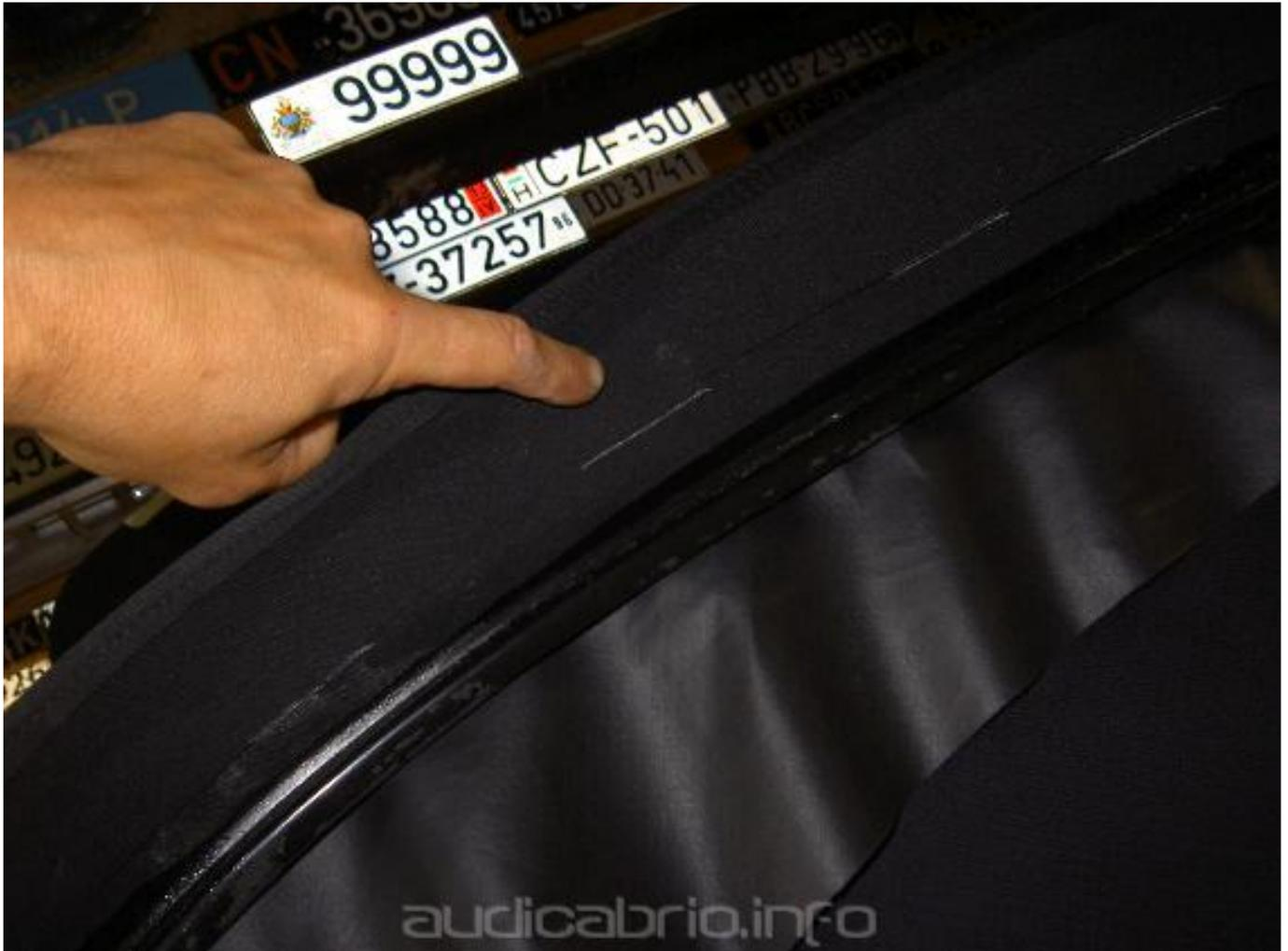
Am Heckspiegel wird jetzt der zweite Lappen zugeschnitten und geklebt. Dabei soll die Spannung gerade so sein das der Keder schön (in Linie mit Verdeck) nach unten zeigt, und schön gleichmässig läuft. Es wird von der Mitte zu den Seiten geklebt.
