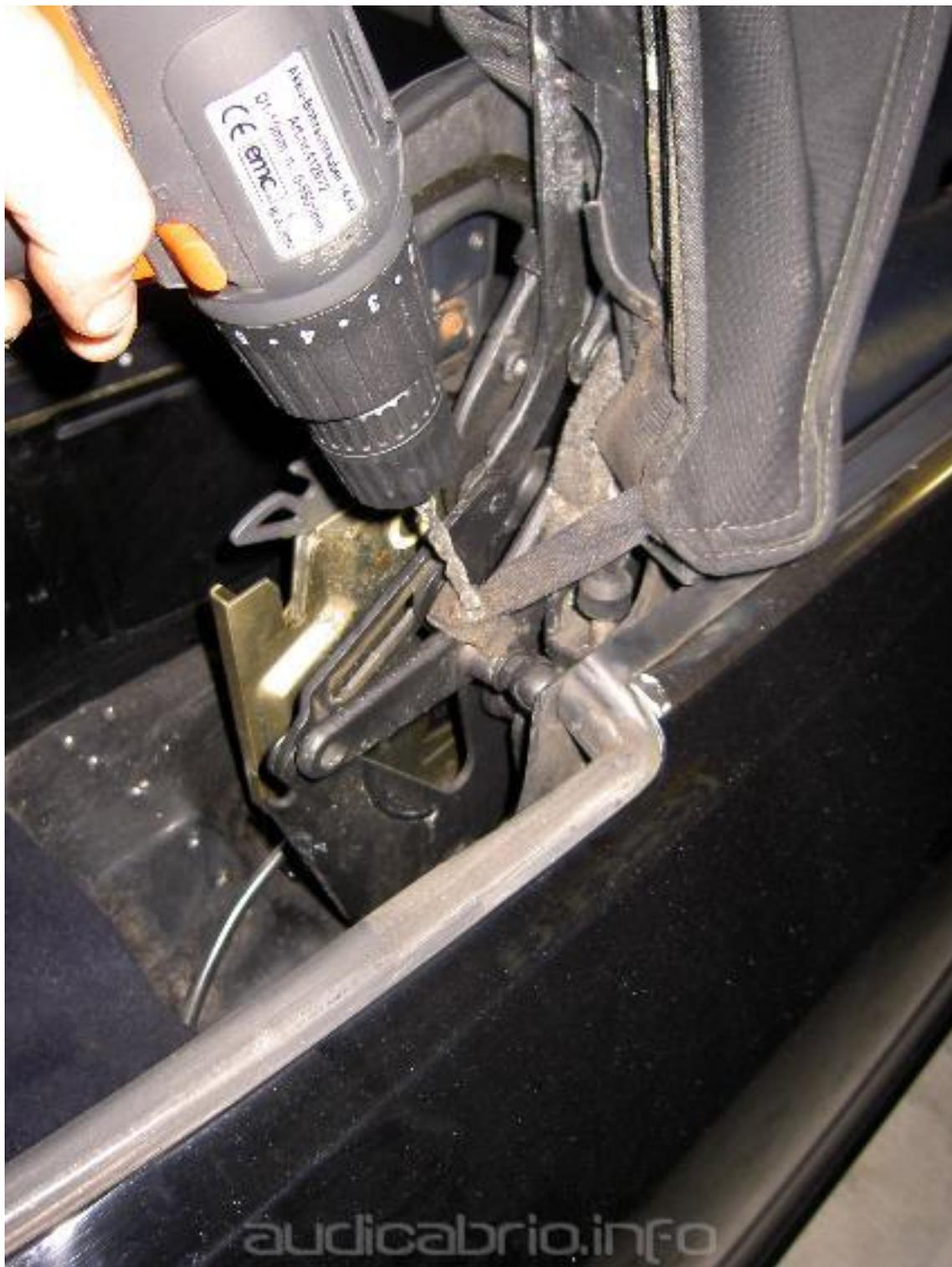
Zwei Gummis halten das Verdeck noch an den Scharnieren mit Blindnieten. Die müssen ausgebohrt werden und sind zu erreichen durch hochklappen vom Heckspiegel und entfernen von Filzlappen am Scharnier.
