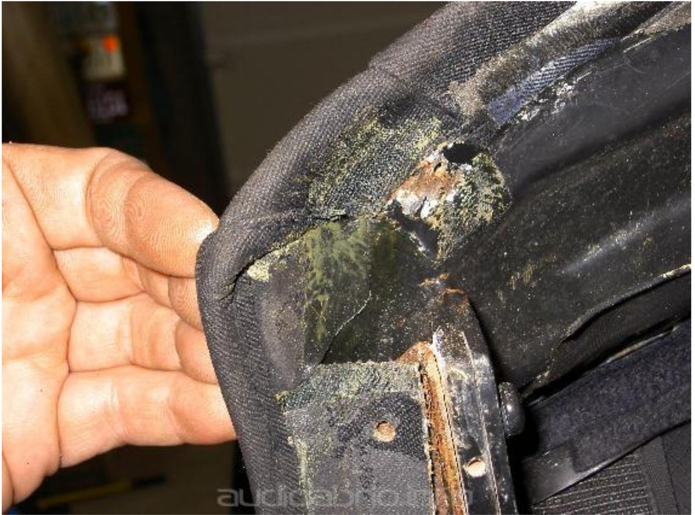
Die vorderen Ecken am Verdeck sind nachher schwierig! Es soll geschnitten, gefaltet und geklebt werden in mehreren Schichten.
