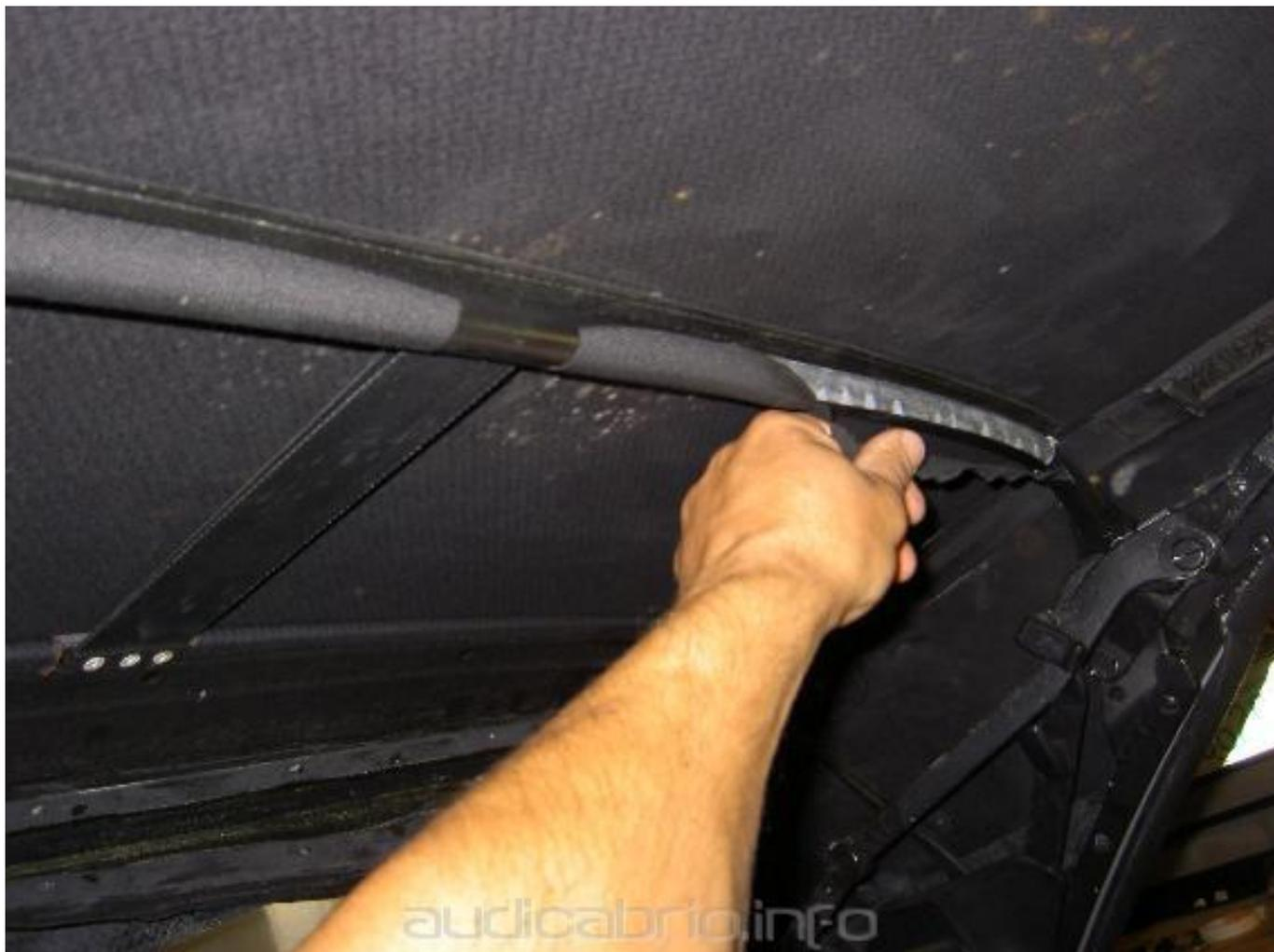
Das Lösen der Zwischen Spriegellappen - auf dem Bild der hintere von drei.
