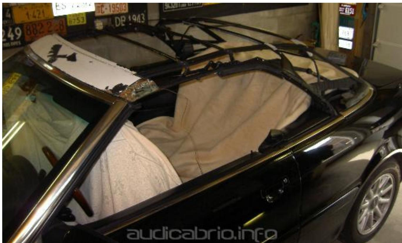
Jetzt ist das Gestänge komplett mit Spannbänder sichtbar, und wird untersucht auf Schäden. Auf jeden Fall müssen alle Kleberreste völlig entfernt werden, eine lästige aber notwendige Arbeit. Am Vorderspiegel sieht Ihr die original verklebte Schaumgummischicht (weiss), für welche ich leider kein Ersatz hatte.
