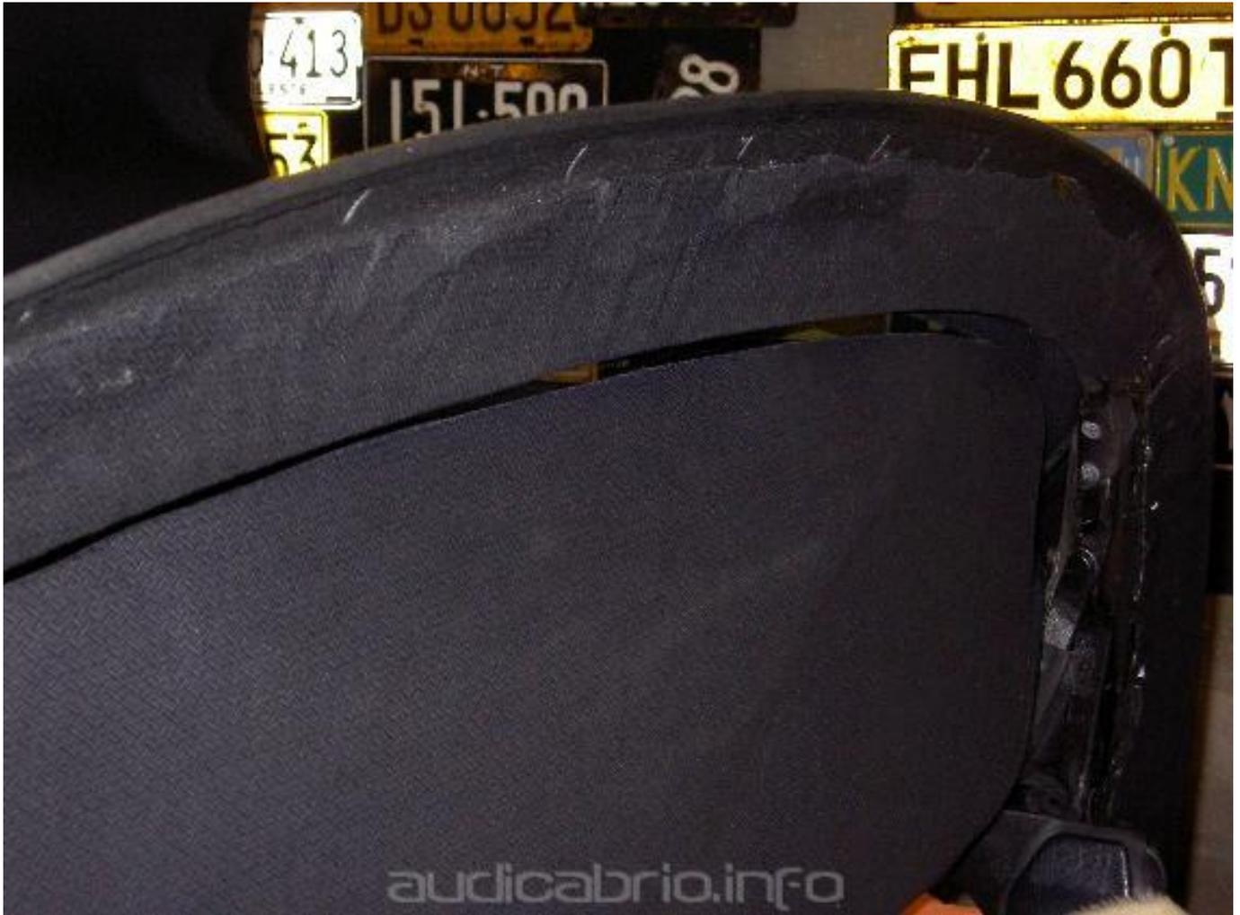
Der Lappen Innenhimmelstoff unter dem Heckfenster wird geklebt, und der hintere Gummi kann wieder montiert werden. Auch über dem Heckfenster wird der Innenhimmelstoff am Hauptspiegel geklebt. (siehe bild 4) Es wird von der Mitte aus, zu den Seiten geklebt.
