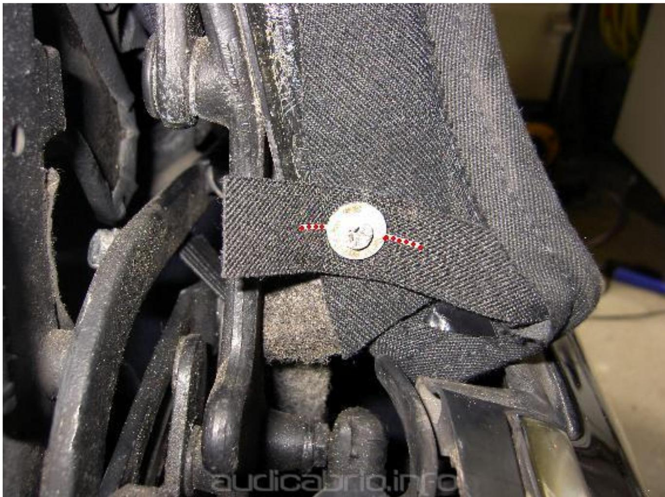
An der Verdeckinnenseite ist an der unteren C-Säulen Ecke einen schmalen extra Lappen genäht. Der wird nicht geklebt sondern in der Mitte in Längsrichtung eingeschnitten (max 1,5 cm-roter strich) und mit der untersten Schraube samt Gummiprofil fest geschraubt. Beim fest ziehen dieser Schraube lässt sich die Ecke mit Hilfe des Lappens ein und ausziehen, damit sie nicht seitlich aus steht.
