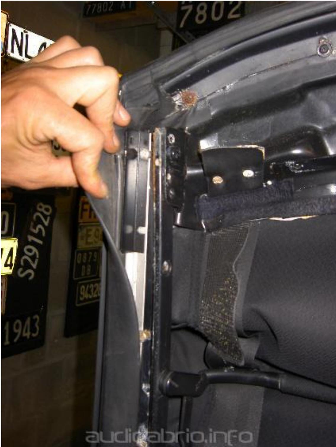
Die Aluminium Profile mit Gummis über den vorderen Seitenfenster abschrauben. Man braucht die Schrauben nur zu Lösen und das Profil kann seitlich raus geschoben werden. Ich habe zu erst die Position der schrauben Markiert auf den Profilen; das nachher neu einstellen der Gummis wird so vereinfacht.
