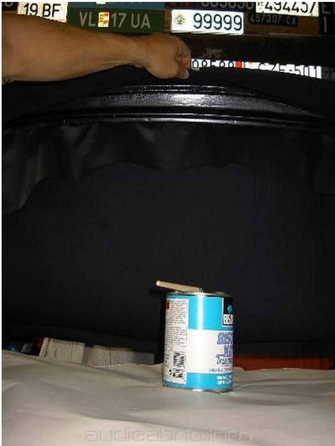
Jetzt kommt erst der Kleber dran, und angefangen wird hinten. Nur der innenliegende Lappen (von 2) wird an dieser Stelle geklebt. Es muss beim kleben darauf geachtet werden dass die obere Naht vom Keder (obwohl da kein Keder drin ist nenne ich das mal so) gut am Spriegel an liegt und sich etwas nach innen zieht.
