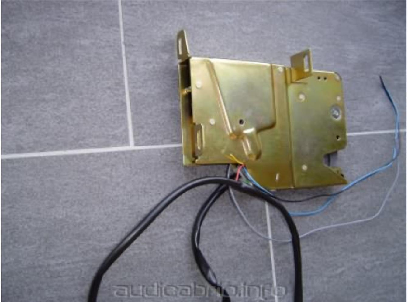
Abbildung 5 Leitungen aus dem Schloss geführt
