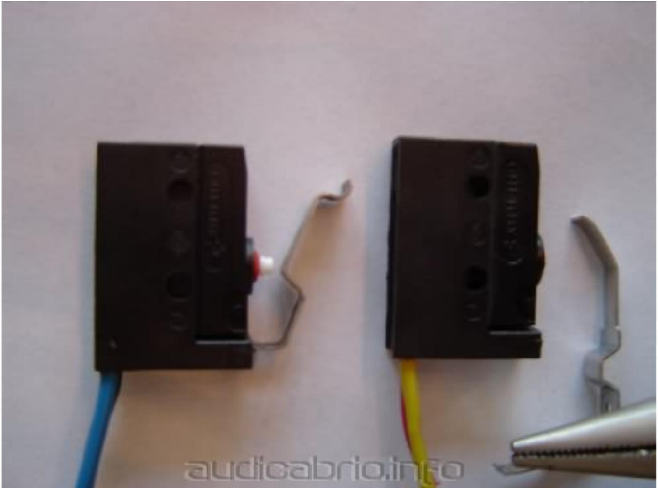
Abbildung 4 Alte Feder an neuem Schalter angebracht
