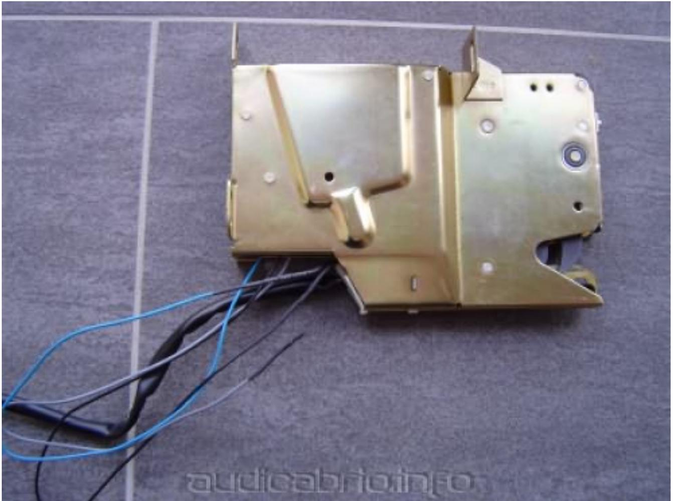
Abbildung 6 Leitungen verbunden und isoliert
