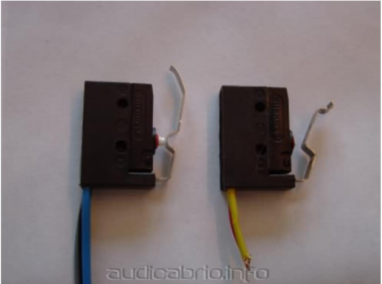
Abbildung 3 Links neuer Schalter, Rechts defekter Schalter
