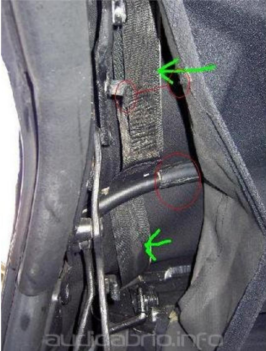
Wenn aber so wie auf diesem Bild (roter kreis) die Quärnaht vom Innenhimmel sich löst von der Klemmbefestigung, muss mindestens von Hand nach genäht werden.
