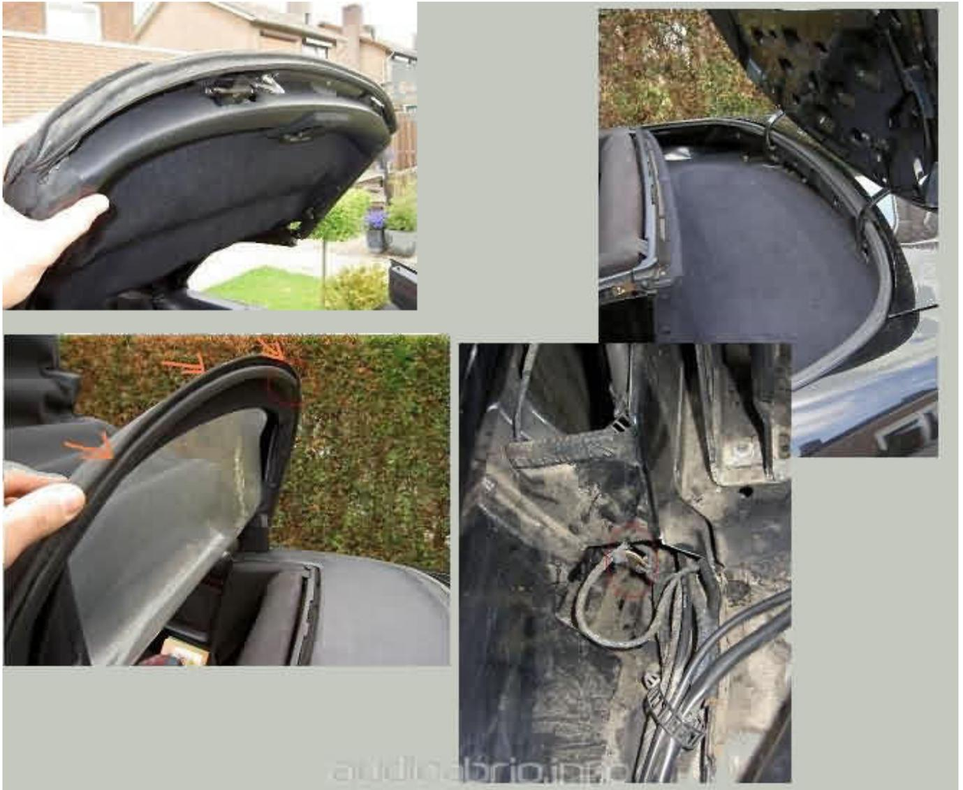
Seht euch auch die Gummis vorn, seitlich, hinten und am Verdeckkasten gut an. Ersatz von ausgetrockneten oder gerissenen Gummis ist teuer !!
