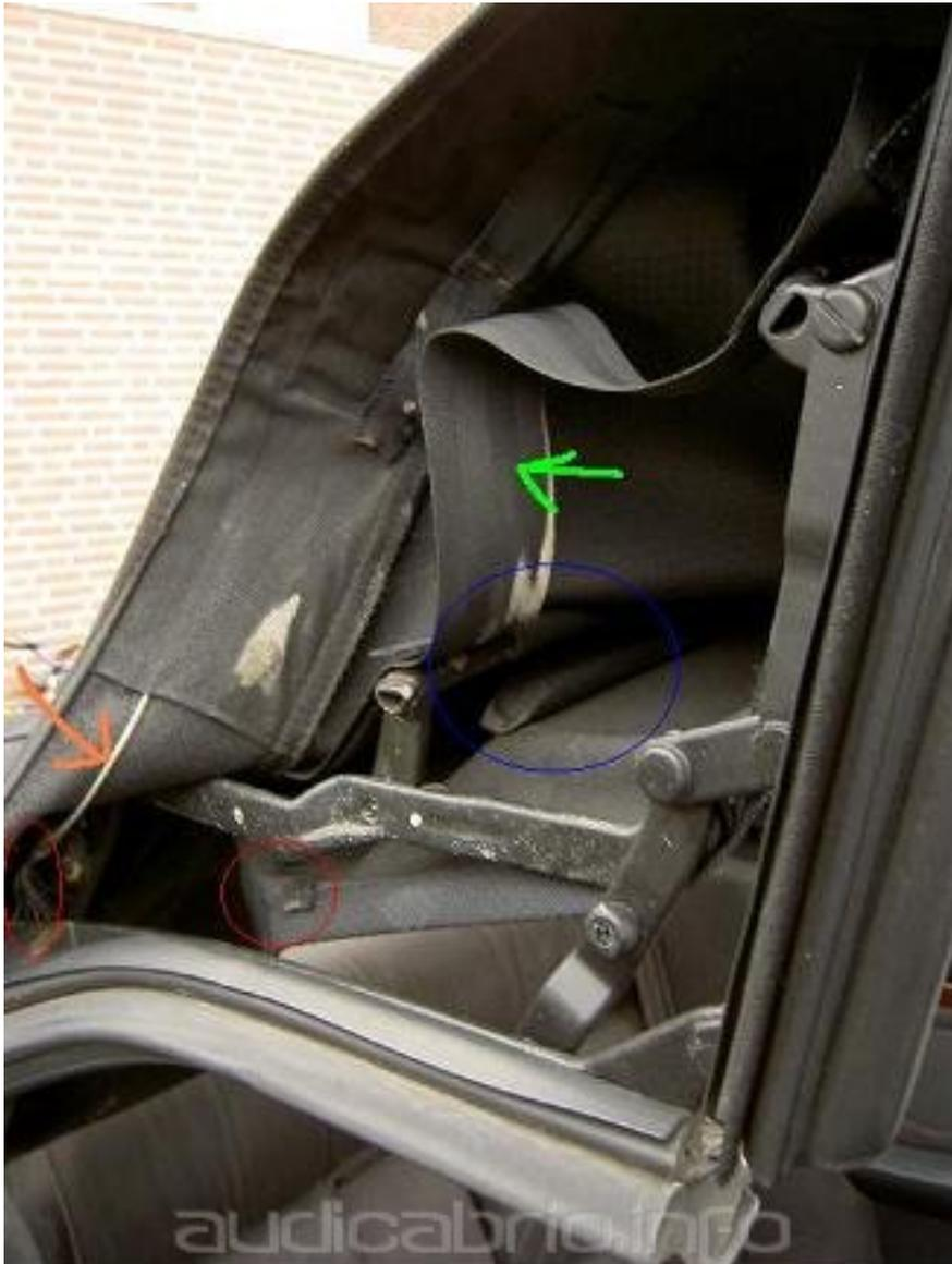
Hier noch mal (R) Spannband (grün) und Spannseil (orange) und die Klemmbefestigung vom Innenhimmel an den Spiegeln (blau). Es gibt Innenhimmeln bei 80-er die nach jeder Verdecköffnung runter kommen. Ein bisschen Kleber links und rechts oder zweiseitiges Klebeband kann helfen.
