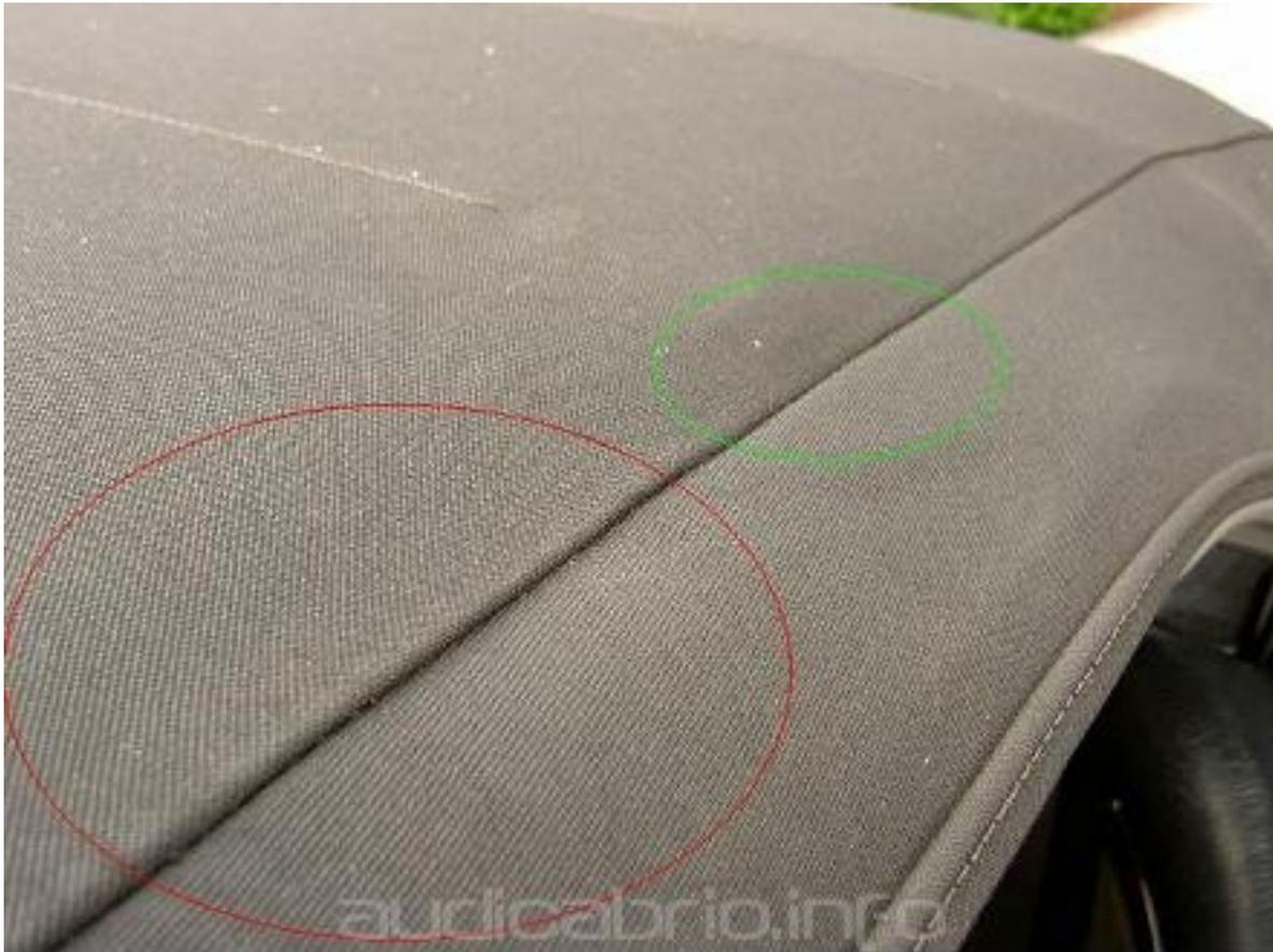
Die Längsnaht soll normalerweise flach verklebt sein, nach einigen Jahren löst sich der Kleber und ist die Naht weniger flach (roter Kreis) als sie sein sollte (grüner Kreis). An sich ist dies nicht so schlimm; es kommt selten zu Wassereintrüben solange die Naht an sich hält.
