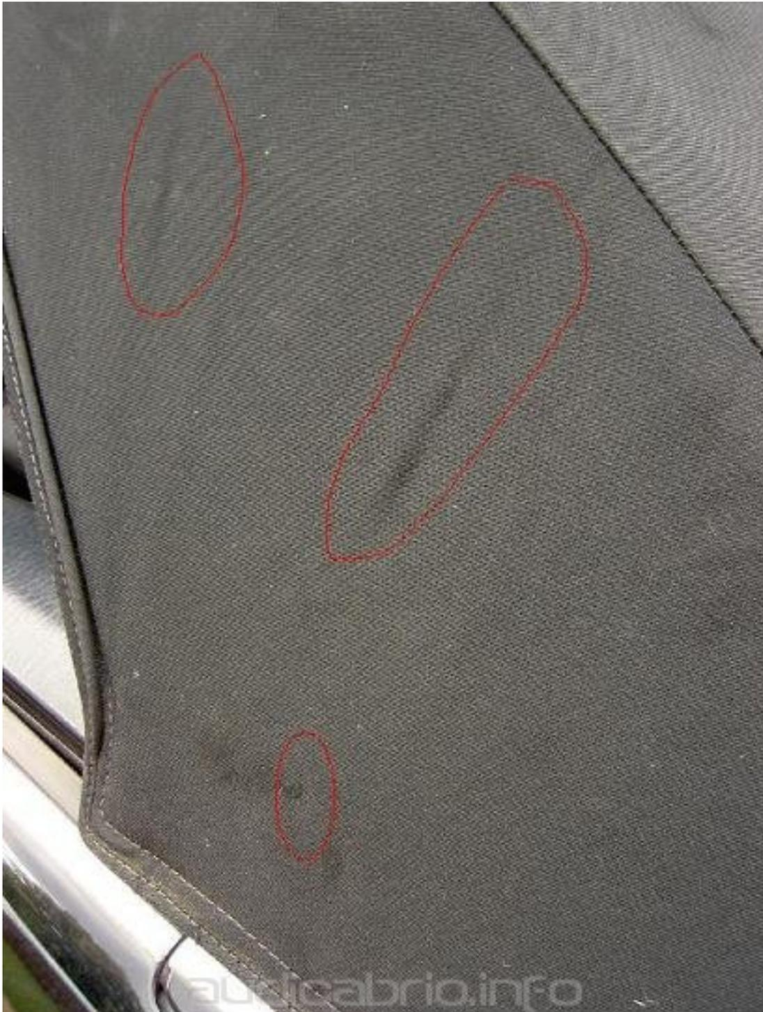
Die hinteren Seitenteile vom Verdeck zeigen dunkle Streifen, Punkte und Flusen; wenn sie mit den fingern drauf drücken fühlt man ob das Gewebe oder die Gummischicht im laufe der Zeit gelitten haben. Diese Stellen werden verursacht von dem Gestänge das beim öffnen und Falten an einander schleift, und versprödete Gummischicht.
