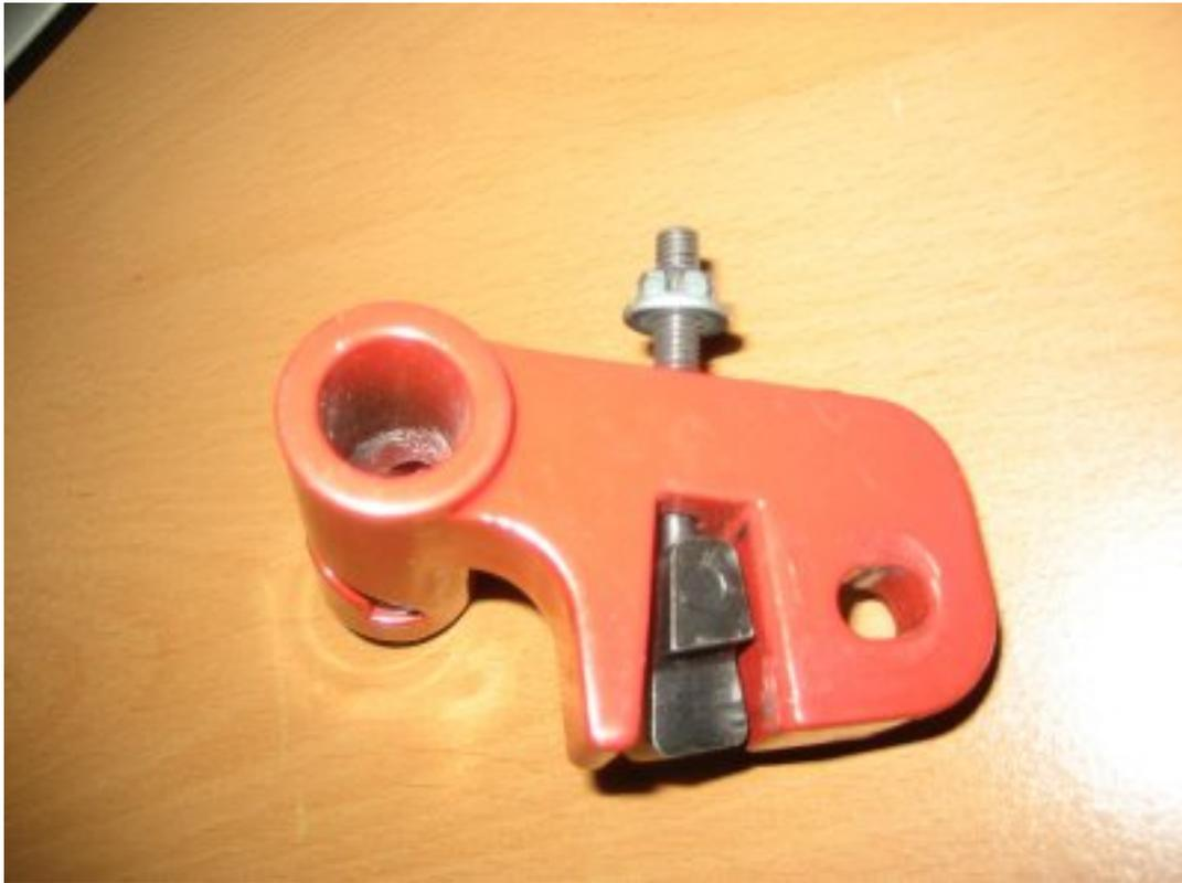
Die 4mm Vertiefung kann man auf den Bildern ganz gut erkennen - das ist quasi die Aussparung, die bei der älteren Version verwendet wird um das Delta mit der zusätzlichen Vertärkung auszugleichen.
