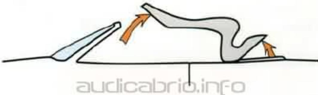
**Schritt 4: Verdeck aufstellen, Taster für Verdeckkastenentriegelung drücken**
