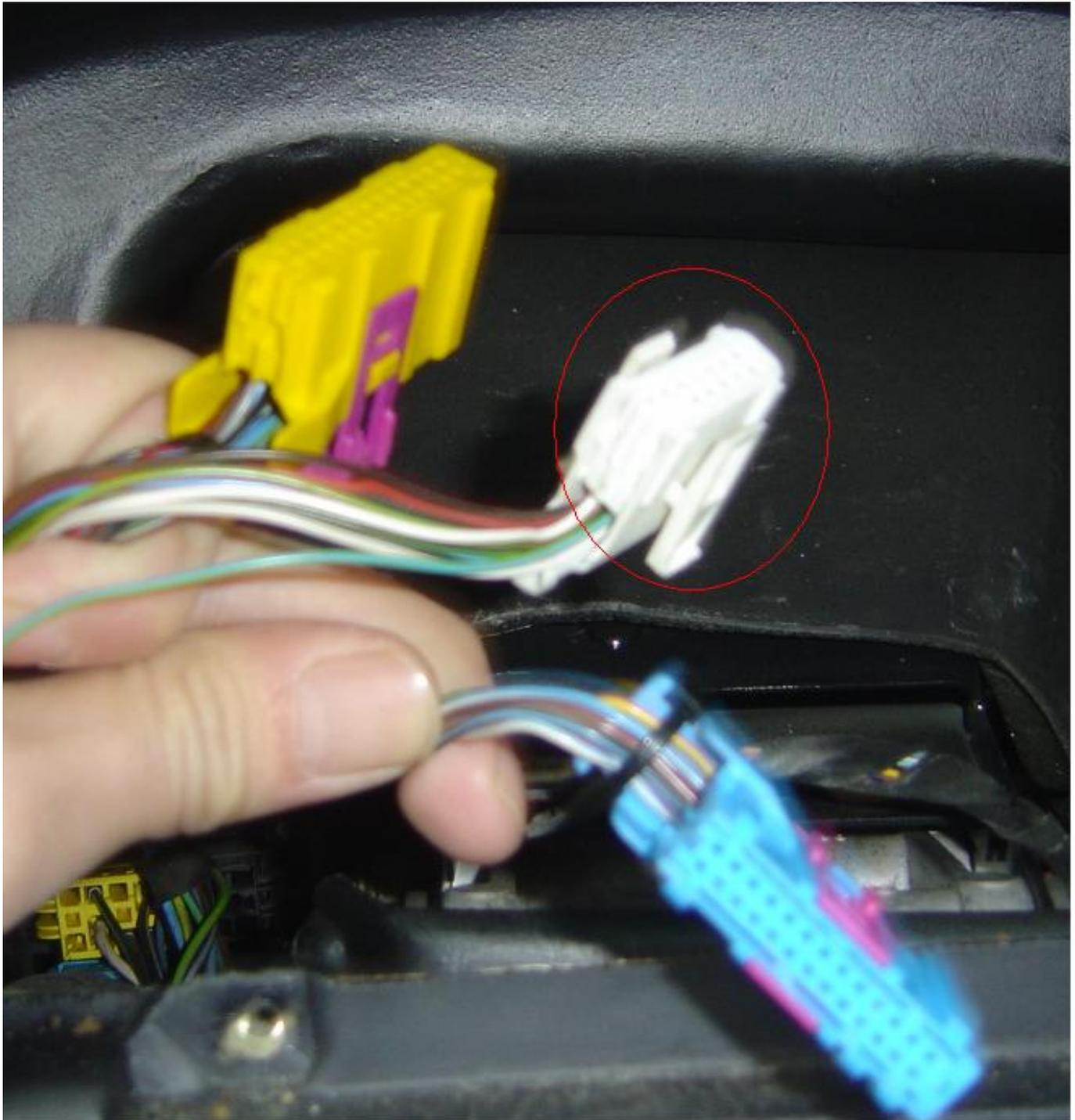
Normalerweise müßten die Stecker mittels Entriegelungswerkzeug entriegelt werden. Man kann den Stecker aber auch vorsichtig aus dem Gehäuse herausziehen, indem man unten am Gehäuse mit einem kleinen Schraubendreher die Rastnase des Steckers nach innen drückt.
