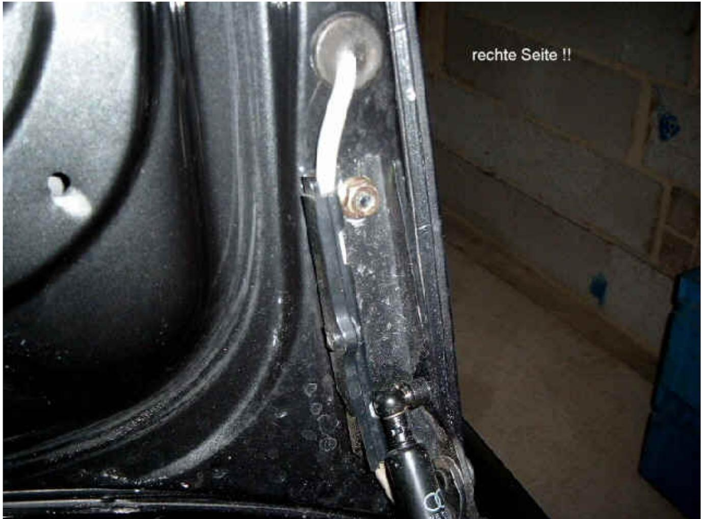
In beiden Kabelbäumen sind die Litzen gebrochen, genau da, wo der Knick ist.
