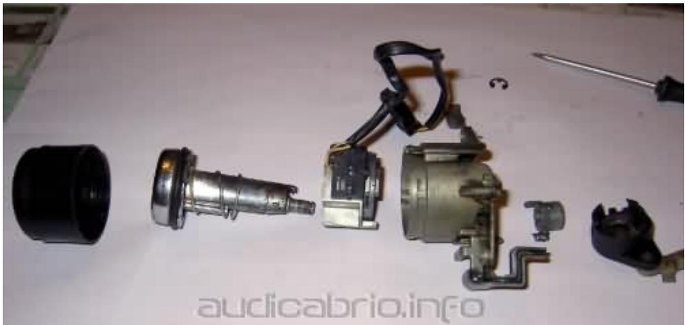
Jetzt soll der Schlüssel"kolben" aus dem Zylinder gezogen werden ABER LASST DEN SCHLÜSSEL DRIN !!! Wenn du ziehst ohne den Schlüssel fliegen sämtliche Teile weg und die sind sehr sehr
