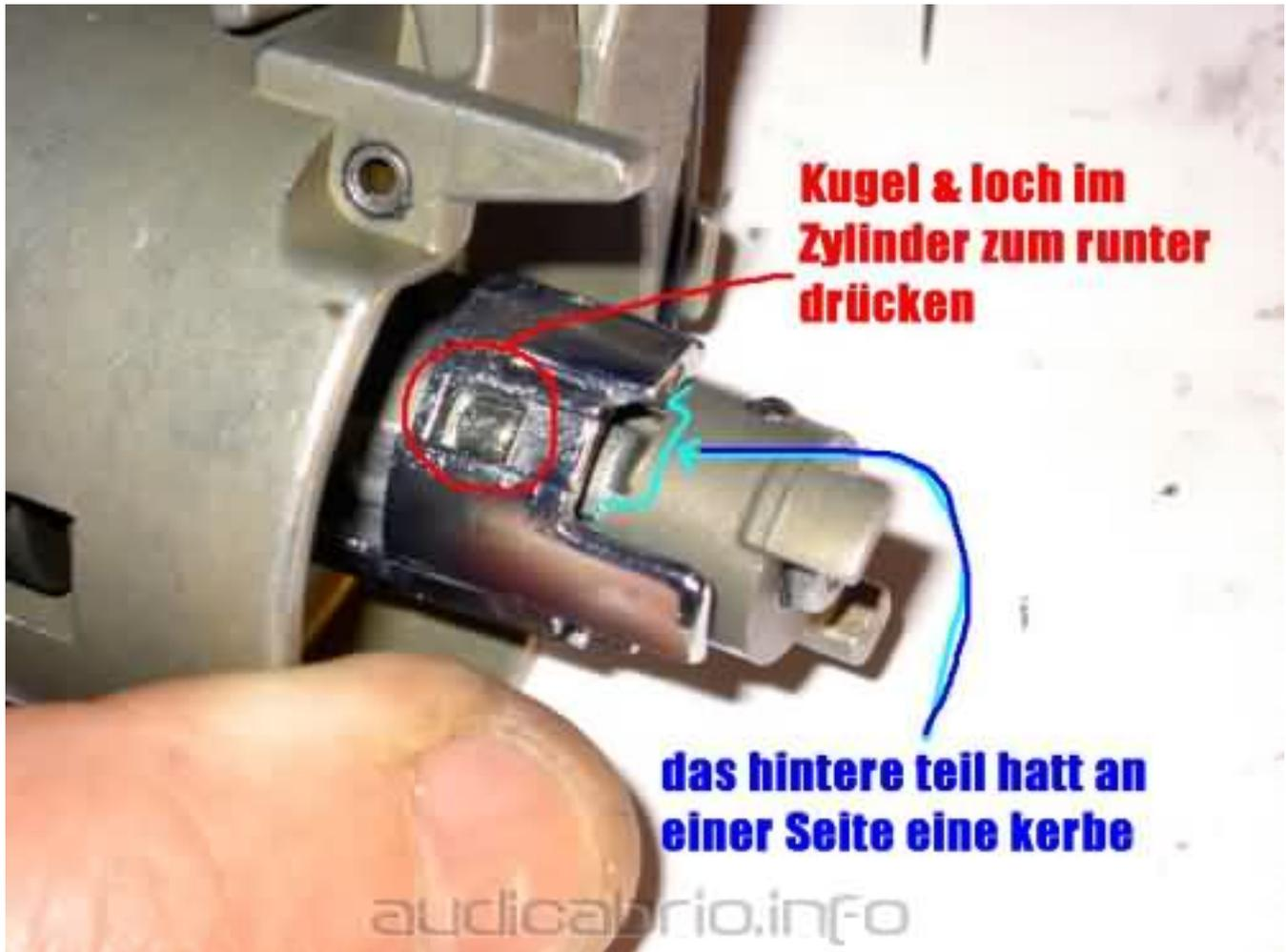
und jetzt das ganze zusammen drückt und gleichzeitig mit einem kleinen Schraubendreher die obere Kugel in die Feder drückt. Bevor das gelingt hasste vielleicht schon fünf mal einen Versuch gemacht!!!
