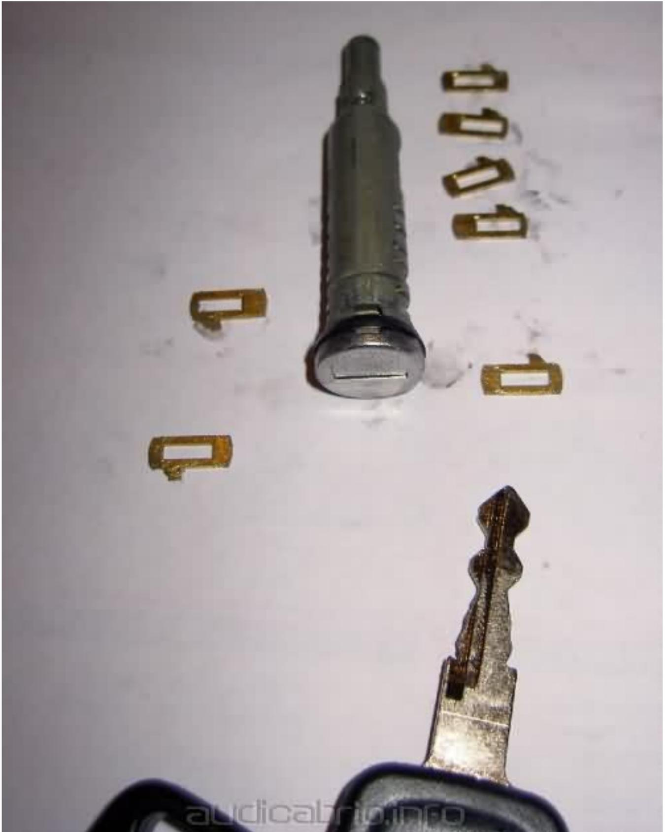
Und wenn beide Kolben "leer" sind sieht das so aus. Aus dem alten Kolben kamen nur sechs, aus dem Neuen sieben Plättchen. Alle Federchen bleiben mit ein bisschen Fett drin. Jetzt gilt es nur noch den alten Schlüssel in den neuen Kolben zu stecken und die Plättchen aus dem alten Kolben einem nach dem anderen auch in den neuen zu stecken (in umgekehrte Reihenfolge als beim Ausbau.
