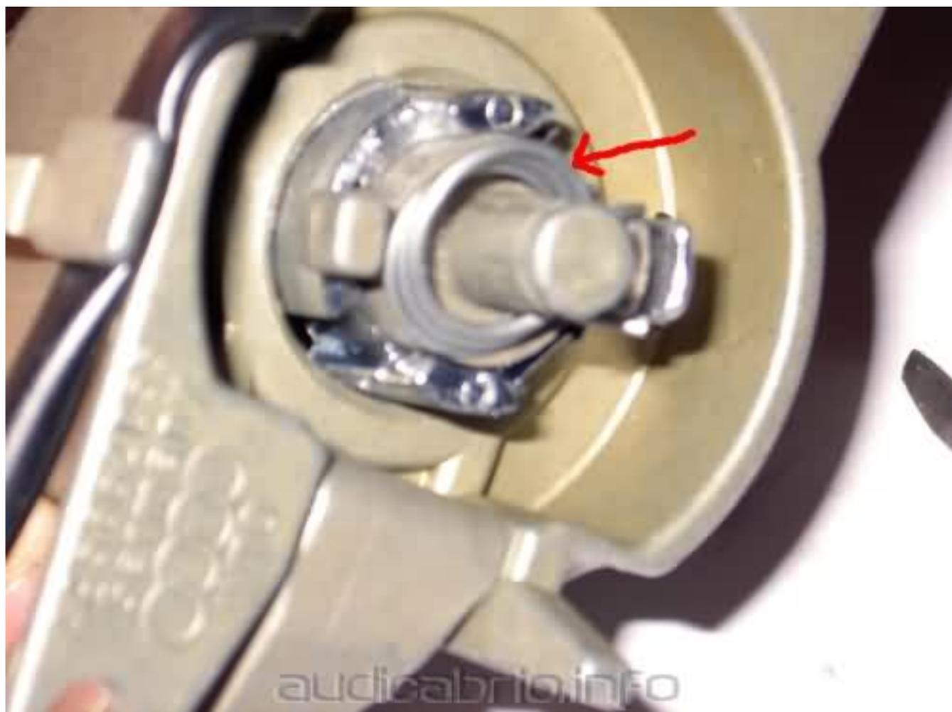
Auch am Neuteil den "Kolben" sammt Schlüssel raus ziehen.
