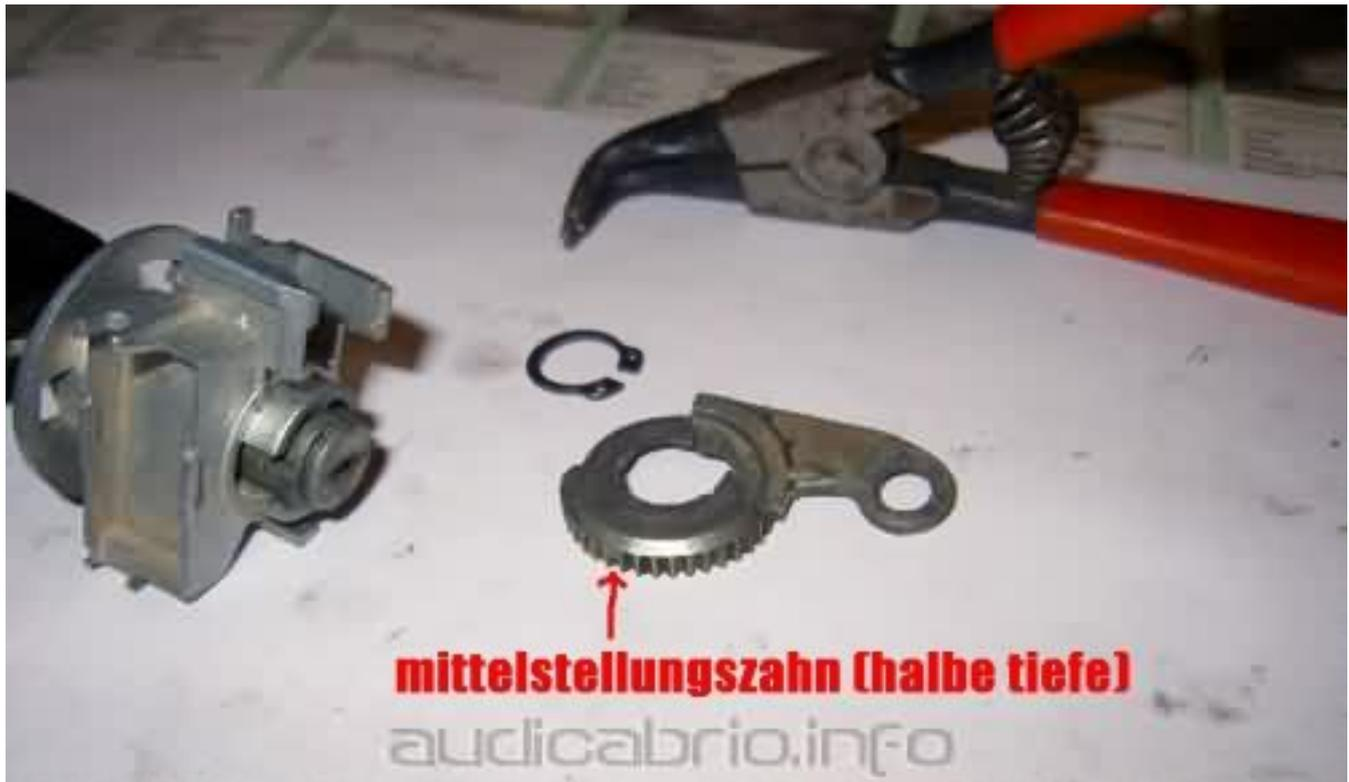
Der Schlüsselkolben auch hier NUR ZIEHEN MIT GESTECKTEM SCHLÜSSEL !!! Das Bild zeigt den Arbeitsvorgang bei ausgebautem Zylinder. Wie gesagt, es geht auch AN der Türe.
