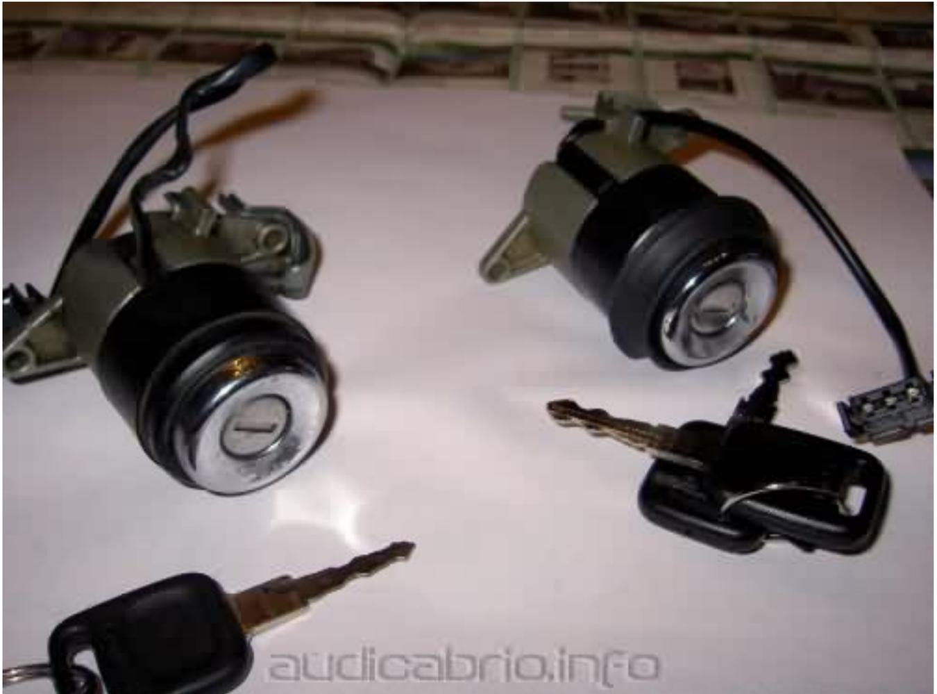
Zerleg erst mal das alte Schloss zur Übung. Hinten dran ist eine Rundfeder die gibt's zu Lösen. Und ab kommt ein Kunststoffteil und Ihr sieht auch direkt den Schwachpunkt: abgebrochene Gussteile vom Zylinder...
