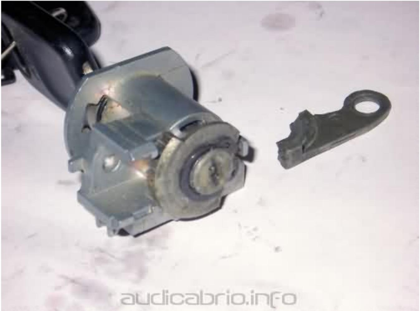
Auseinanderbauen vom Zylinder und Kolben ist auch mit einer Rundfeder (spezial Zange sehr hilfreich !)
